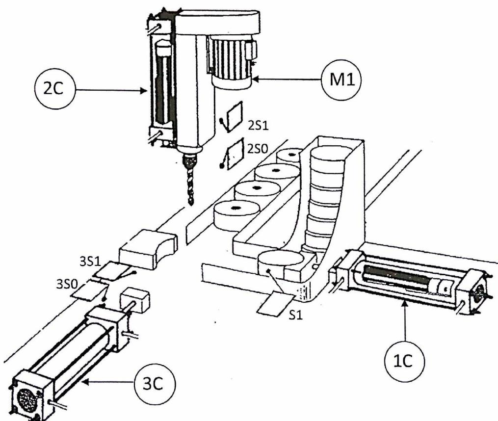
L'installation ci-avant permet de percer automatiquement des pièces cylindriques.
