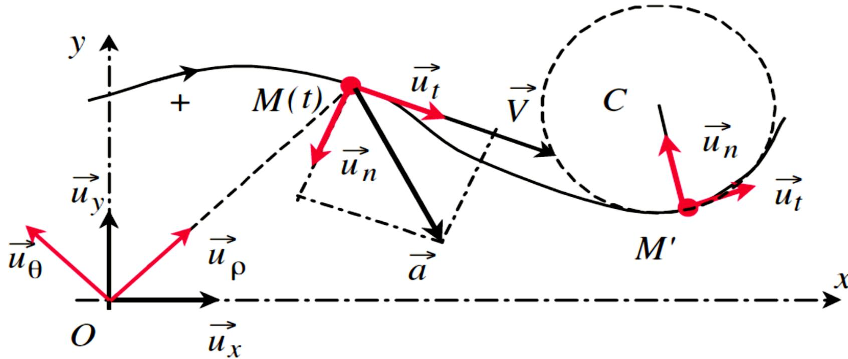
**Figure 1.18** Le vecteur accélération et la base de Frenet  $(\vec{u}_t, \vec{u}_n)$ . Le rayon de courbure en  $M'$  correspond au rayon  $CM'$  du cercle tangent à la trajectoire au point  $M'$  considéré. Les bases polaire et cartésienne sont représentées au point  $O$  pour mettre en évidence les différences avec la base de Frenet.
