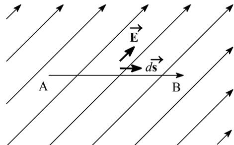
où  $V_A, V_B$  sont les potentiels aux points A et B en volts,
