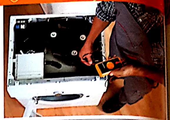
Doc. 5 Mesure au voltmètre de la tension du secteur. ATTENTION, DANGER !
