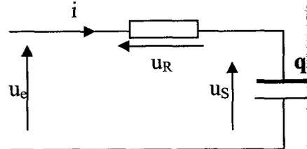
1) a- En appliquant la loi des mailles, déterminer l'équation différentielle régissant l'évolution de la tension de sortie  $u_s(t)$ .
