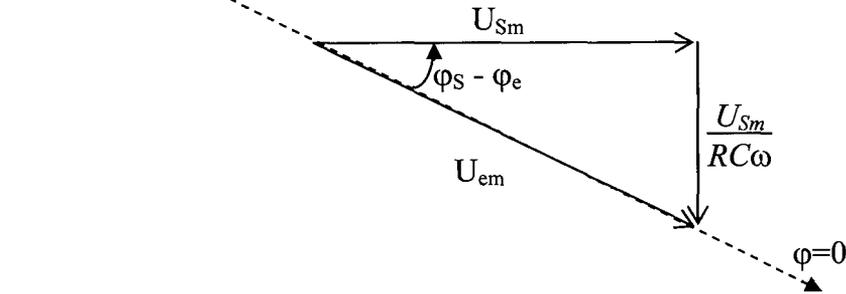
$u_e = \frac{1}{RC} \int u_s dt + u_s$  avec  $u_e = U_{em} \sin(\omega t + \varphi_e)$  et  $u_s = U_{sm} \sin(\omega t + \varphi_s)$
