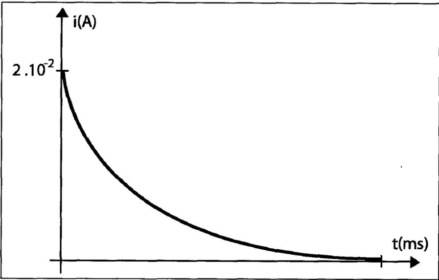
b- L'allure de cette courbe peut être fournie par la tension  $u_R$  car  $u_R = R.i$ . Cette tension n'est pas observable avec le montage proposé à cause d'un problème de masse.
