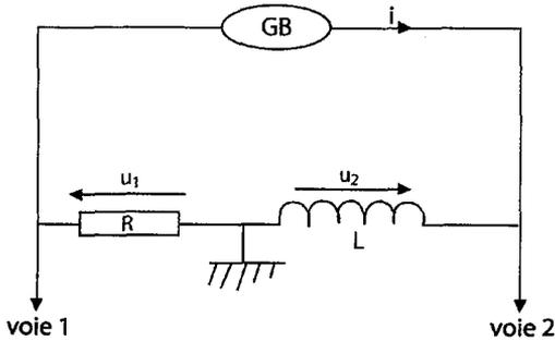
A l'aide d'un oscilloscope bi-courbe, on visualise les tensions  $u_1$ , sur la voie 1, et  $u_2$  sur la voie 2, on obtient les oscillogrammes suivants :
