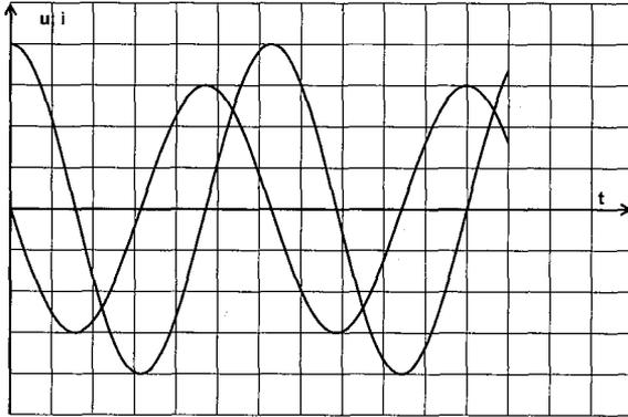
$$\varphi_i - \varphi_u = \pi - \frac{\pi}{2} = +\frac{\pi}{2} \Rightarrow i(t) \text{ est en quadrature avance de phase par rapport à } u_C(t)$$
