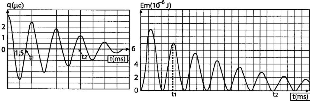
correspondent respectivement aux variations de la charge  $q$  du condensateur et de l'énergie magnétique  $E_m$  emmagasinée dans la bobine en fonction du temps.
