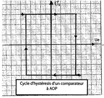
Oscilloscope en mode XY
