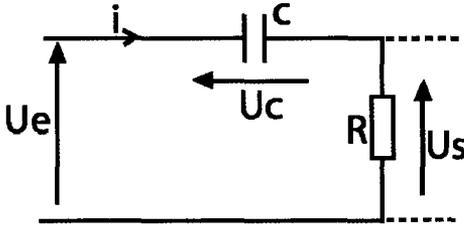
2-La fréquence de coupure du filtre est obtenue lorsque  $G = G_0 - 3dB$ .
