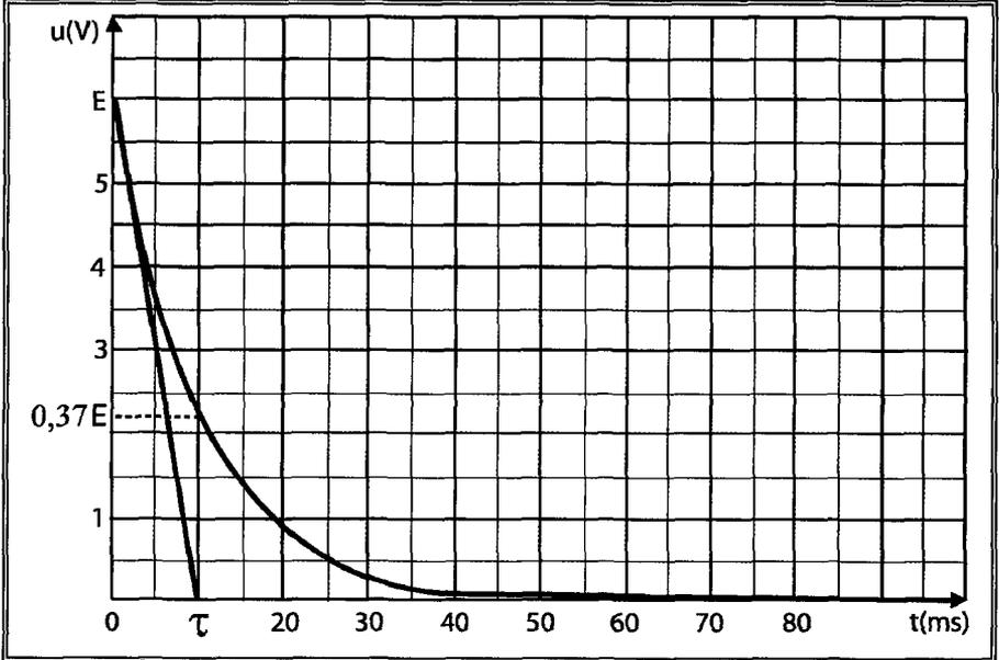
• La tension aux bornes d'un condensateur ne subit pas de brusque variation, c'est une fonction continue du temps.
