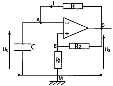
c. Cette équation différentielle admet une solution de forme  $u_c(t) = Ae^{-\frac{t}{C}} + B$  avec  $C = RC$
