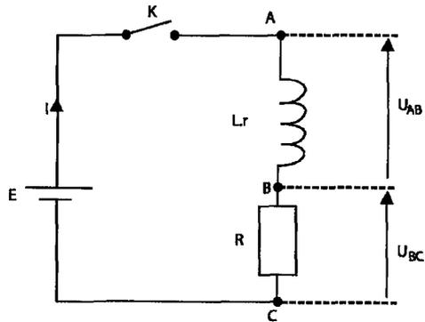
4) Un dispositif approprié permet de suivre les valeurs des tensions  $u_{AB}$  et  $u_{BC}$  au cours du temps.
