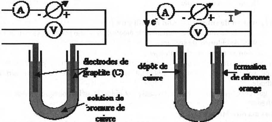
Lorsque la tension appliquée est trop faible ( $U < 1,2\text{V}$ ) il ne se passe rien. Pour une tension appliquée supérieure à  $1,2\text{V}$ , on observe un dépôt de cuivre sur l'électrode négative (cathode) et l'apparition de dibrome en solution au voisinage de l'électrode positive (anode).
