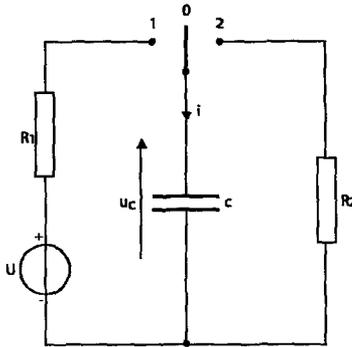
I- A  $t=0$  on bascule l'interrupteur à la position 1. On obtient sur l'écran de l'oscilloscope les deux courbes A et B de la figure suivante :
