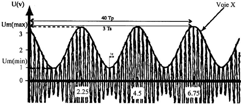
$$\text{Pour } T_s : 3T_s = 6,75 - 0 = 6,75 \text{ donc } T_s = \frac{6,75}{3} = 2,25 \text{ms}$$
