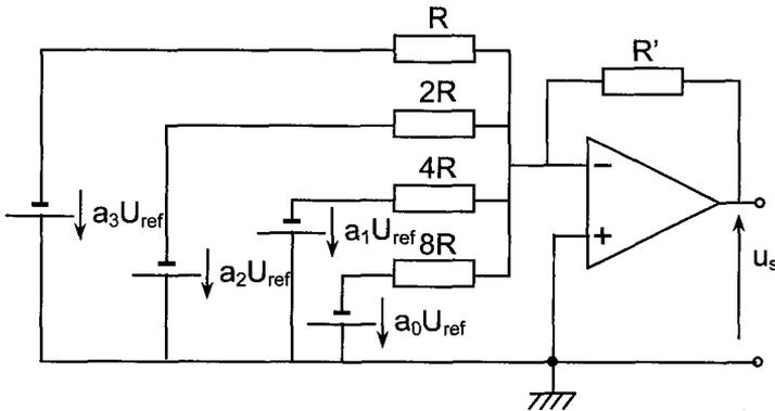
Schéma équivalent simplifié d'un CNA à 4 bits
