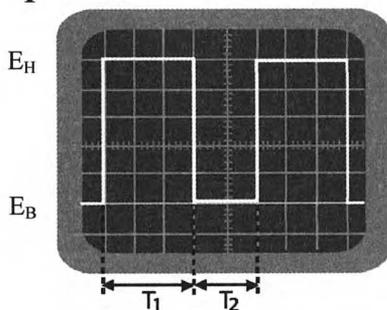
• **Multivibrateur astable à amplificateur opérationnel**
