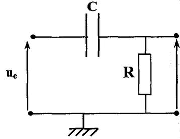
1) a- En appliquant la loi des mailles, déterminer l'équation différentielle régissant l'évolution de la tension de sortie  $u_s(t)$ .
