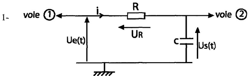
2- Pour un filtre passe pas passif  $u_e = (t)$  est toujours en avance de phase par rapport à  $u_s = (t)$  d'où la courbe B correspond à  $u_e = (t)$ . La courbe A représente  $u_s = (t)$ .
