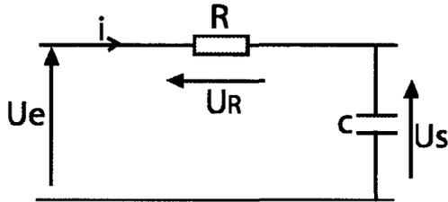
L'équation  $\textcircled{1}$  devient  $u_s + RC \frac{du_s}{dt} = u_e$  : c'est l'équation différentielle relative à  $u_s$
