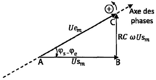
La transmittance du filtre est  $T = \frac{U_{sm}}{U_{em}} = \frac{1}{\sqrt{1 + (RC\omega)^2}}$ , le gain du filtre
