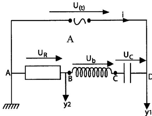
$$2) \ a - U_m = Z I_m \text{ avec } Z = \sqrt{(R+r)^2 + (\frac{1}{C\omega} - L\omega)^2}$$
