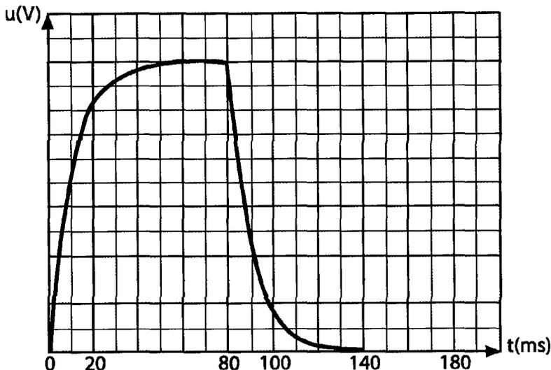
➤ Lorsqu'on ferme l'interrupteur, le courant s'installe progressivement, sans la bobine, il aurait instantanément la valeur finale.
