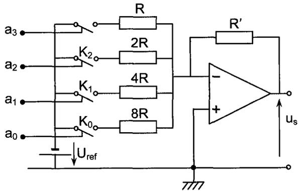
Dans le cas d'un convertisseur à 4 bits le schéma est donné par la figure ci contre :
