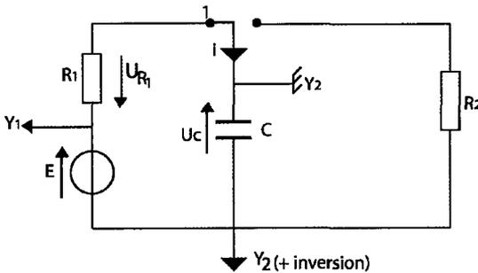
b- Au cours de la charge la tension aux bornes du condensateur croit (à partir de 0 si le condensateur est initialement déchargé) d'où :
