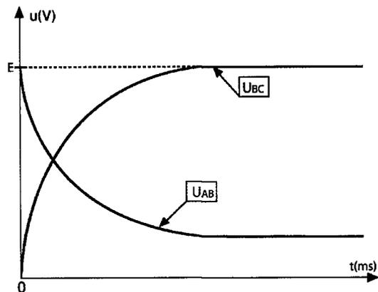
5) lorsque la bobine devient purement inductive  $r = 0$
