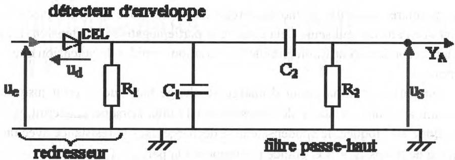
Le condensateur  $C_2$  élimine la composante continue de la tension.
