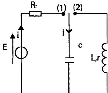
bobine d'inductance  $L$  et de résistance  $r$ . La résistance  $R_1=200\ \Omega$ .
