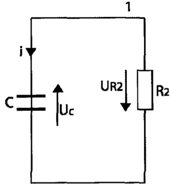
2) La solution de l'équation différentielle est :  $u_C = E \cdot e^{-\frac{t}{\tau}}$  avec  $\tau = R_2 C$
