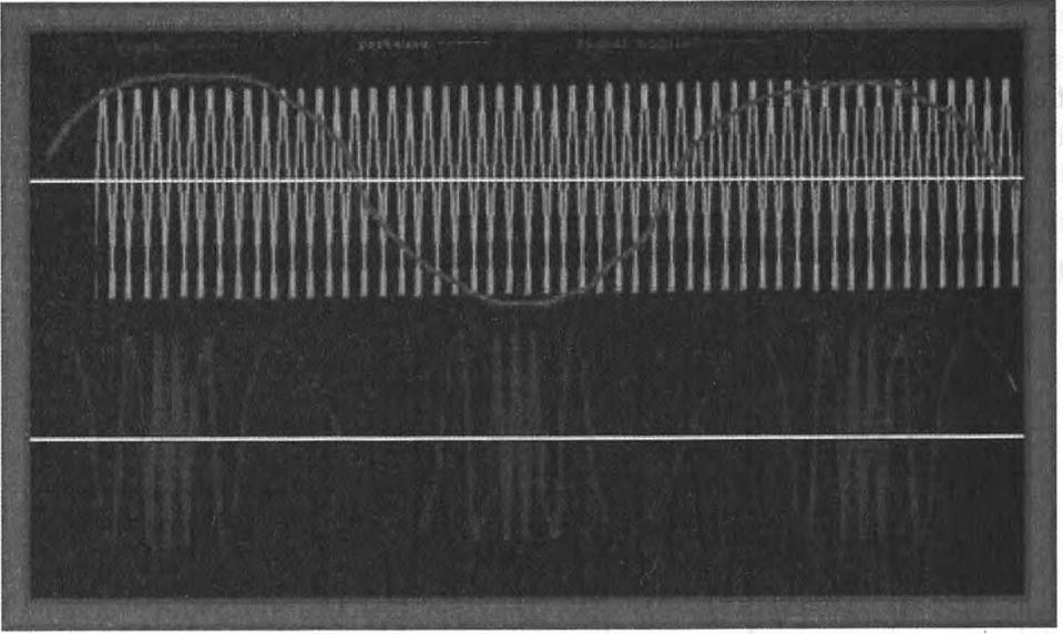
Un exemple de modulation de fréquence. En haut, le signal (en rouge) superposé avec la fréquence porteuse (en vert). En bas, le résultat du signal (en bleu) une fois modulé par la fréquence.
