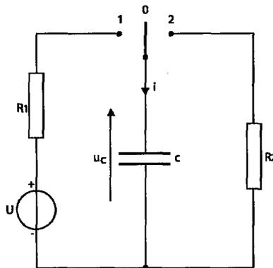
I- A l'instant  $t=0$ , on place le commutateur  $K$  dans la position 1. Un oscilloscope à mémoire permet d'obtenir les courbes de variation de la tension  $u_C(t)$  aux bornes du condensateur et la tension  $u_{R_1}(t)$  aux bornes du résistor  $R_1$ .
