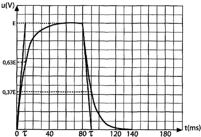
❖ Lors de la rupture du courant, on trace la tangente à la courbe à l'instant  $t_0$  d'ouverture du circuit, elle coupe l'axe des abscisses à l'instant  $t_0 + \tau$  (on considère  $t_0$  comme nouvelle origine)
