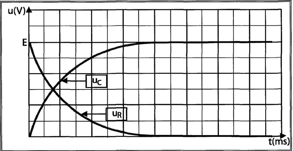
L'intensité du courant décroît jusqu'à s'annuler.
