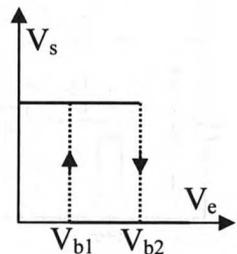
transfert de la porte CMOS 4093 avec  $V_{b1} = \frac{1}{2} V_{dd}$  et
