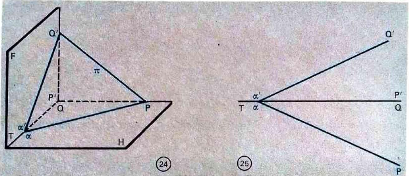
Sur la figure 25, nous avons représenté un plan  $\pi$  qui n'est perpendiculaire à aucun des deux plans H et F.
