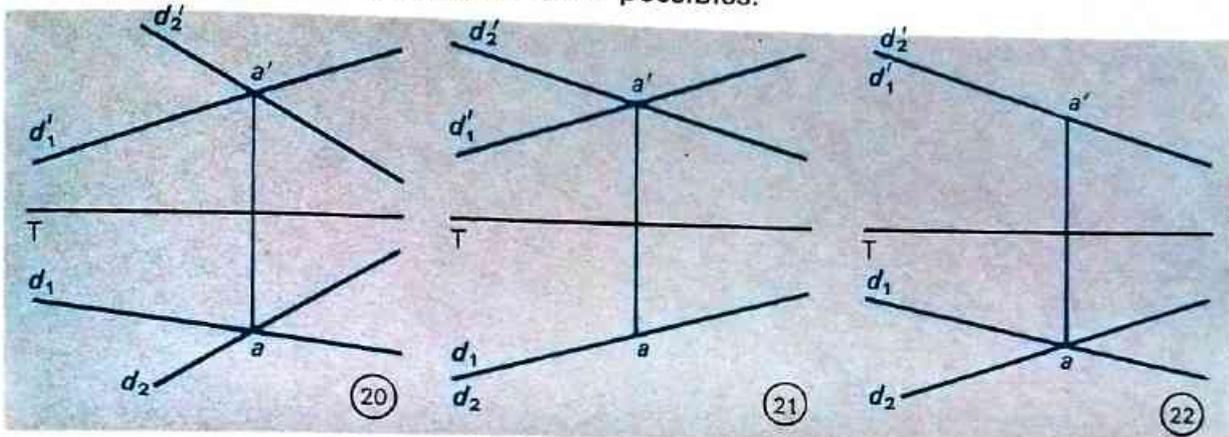
1.  $d_1 \cap d_2 = \{a\}$ ,  $d'_1 \cap d'_2 = \{a'\}$  et les points  $a$  et  $a'$  sont sur une même ligne de rappel (fig. 20).
