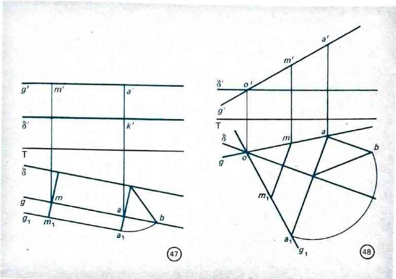
**Premier cas :**  $G$  est parallèle à  $D$  (fig. 47).  $g_1$  est donc la droite qui est parallèle à  $D$  et qui passe par  $a_1$ . Le point  $m_1$  appartient à  $g_1$ . De plus  $m_1$  appartient à la droite qui est perpendiculaire à  $\delta$  et qui passe par  $m$ . Le point  $m_1$  est donc le point d'intersection de ces deux droites.
