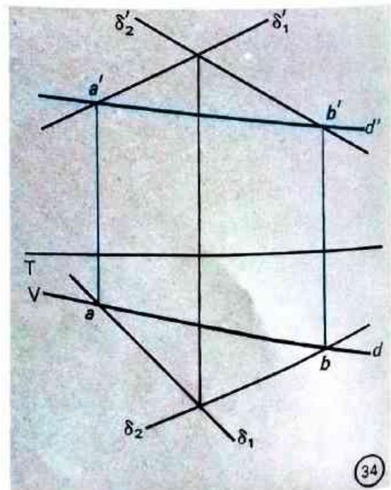
La projection horizontale  $d$  est V. Elle coupe  $\delta_1$  et  $\delta_2$  respectivement en  $a$  et en  $b$ . Les projections frontales sont  $a'$  et  $b'$ . La droite  $d'$  est la droite déterminée par les points  $a'$  et  $b'$ .
