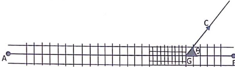
a) Précise selon l'angle  $\widehat{BGC}$ , si cette force s'oppose au mouvement du wagonnet, si elle n'a aucun effet sur ce mouvement ou au contraire l'amplifie.
