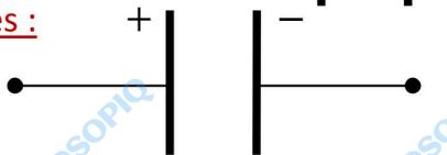
*Condensateur chimique ou électrolytique polarisé*
