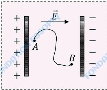
Considérons le champ électrostatique uniforme  $\vec{E}$  entre les armatures d'un condensateur. Un porteur de charge  $q$  en mouvement dans ce champ entre deux points  $A$  et  $B$ , subit la force électrostatique constante  $\vec{F}_e = q\vec{E}$ . On néglige le poids. Le travail de cette force a pour expression :
