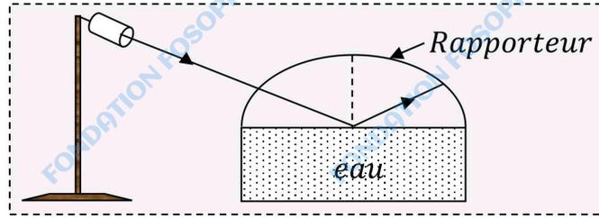
On envoie un pinceau lumineux sur une surface d'eau. On relève les angles sur le rapporteur :  $i_1$  et  $i_2$ .
