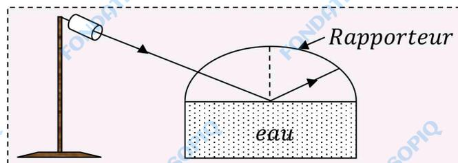
On envoie un pinceau lumineux sur une surface d'eau. On relève les angles sur le rapporteur :  $i$  et  $i'$ .
