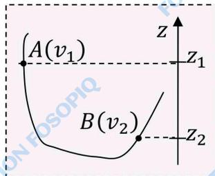
A l'instant  $t_1$ :  $E_1 = mg(z_1 - z_0) + \frac{1}{2}mv_1^2$
